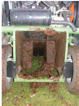
▲ Leikkuuteriltä on suora yhteys säiliöön. Järjestelmässä ei ole tukkeutuvia kohtia. Märissä olosuhteissa työskenneltäessä säiliötä nostettaessa maahan lorahtaa talikollinen silppua.
