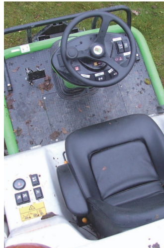
▲ 124:ssä hallintalaitteet ovat molemmilla sivuilla ja kojetaulussa. Istuimelle on helppo nousta ja jalkatilaa on riittävästi.
