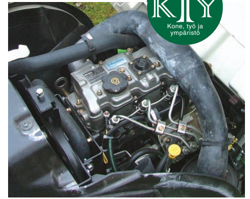
▲ Satasessa Perkinsin moottori on kaksinkertaisen kopan alla, joten moottorin melu on hyvin alhainen. Koneet ovat helposti huollettavia, kohteisiin pääsee hyvin käsiksi.
