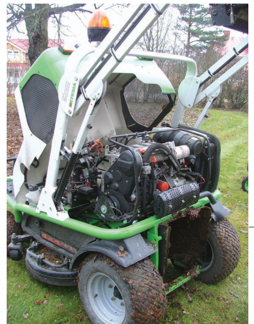
▲ 124:n konehuone on takana hyvin huollettavissa, kun kerääjän nostaa ylös. Suojaisessa paikassa roskat eivät pääse moottoritalaan.
